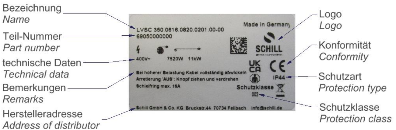
Abb. 1.2.2: Produktetikett am Beispiel einer LVSC 350
