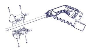
Mit dem Kabelstopper stellt man die Griffhöhe des heraushängenden Kabelendes individuell ein. Die Lamellen-Klemmung passt sich unterschiedlichen Kabeldurchmessern von 6 bis 16mm an. Für größere Durchmesser muss der Kabelstopper erweitert werden (Kabeldurchmesser – 1,5mm). Der Stopper dient auch als Sicherung gegen ein Einziehen des Kabels beim versehentlichen Loslassen. Er sollte daher niemals entfernt werden.
