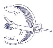
Das schwenk- und feststellbare Rollenjoch, mit den vier leichtgängigen Laufrollen, garantiert eine problemlose Kabelführung. Der Kabelaufroller stellt sich immer in Zugrichtung ein, das Kabel kann nicht über die Seitenflansche rutschen und bleibt immer auf dem Wickelkörper.
