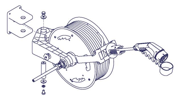
Der Kabelaufroller ist um 150° schwenkbar. Mit einem Arretier- Bolzen (optionales Zubehör) kann der Aufroller arretiert werden.
