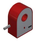
Der im Aufroller integrierte DC-Wächter besitzt einen Test-Knopf zur Überprüfung der Fehlerstromschutzeinrichtung. Bei Betätigen wird ein 6 mA DC-Fehlerstrom generiert. Daraufhin erzeugt der DC-Wächter einen AC-Fehlerstrom, welcher den in der Hausverteilung vorhandenen Fehlerstromschutzschalter auslöst.
