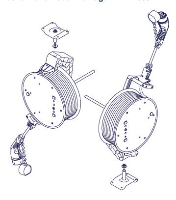
Das drehbare Rollenjoch ist je nach Montagehöhe auf die Kabelzugrichtung zu stellen und fest zu schrauben
